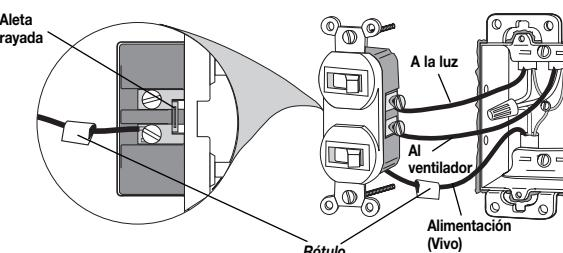
**MARQUE** el cable que está conectado al costado de alimentación del interruptor (el costado con la aleta rayada).
